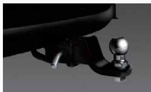
Gancho de arrastre y cableado
